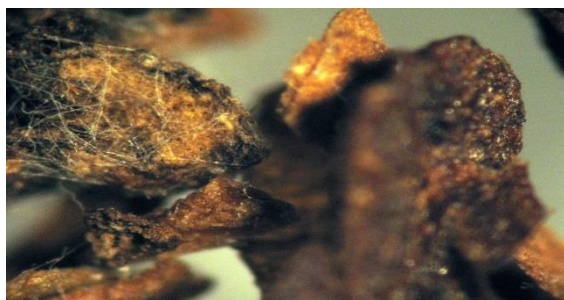
Ξένο σώμα μικροβιολογικής προέλευσης. Υφές μούχλας σε υλικό πλήρωσης παραπονημένων τσιγάρων.
