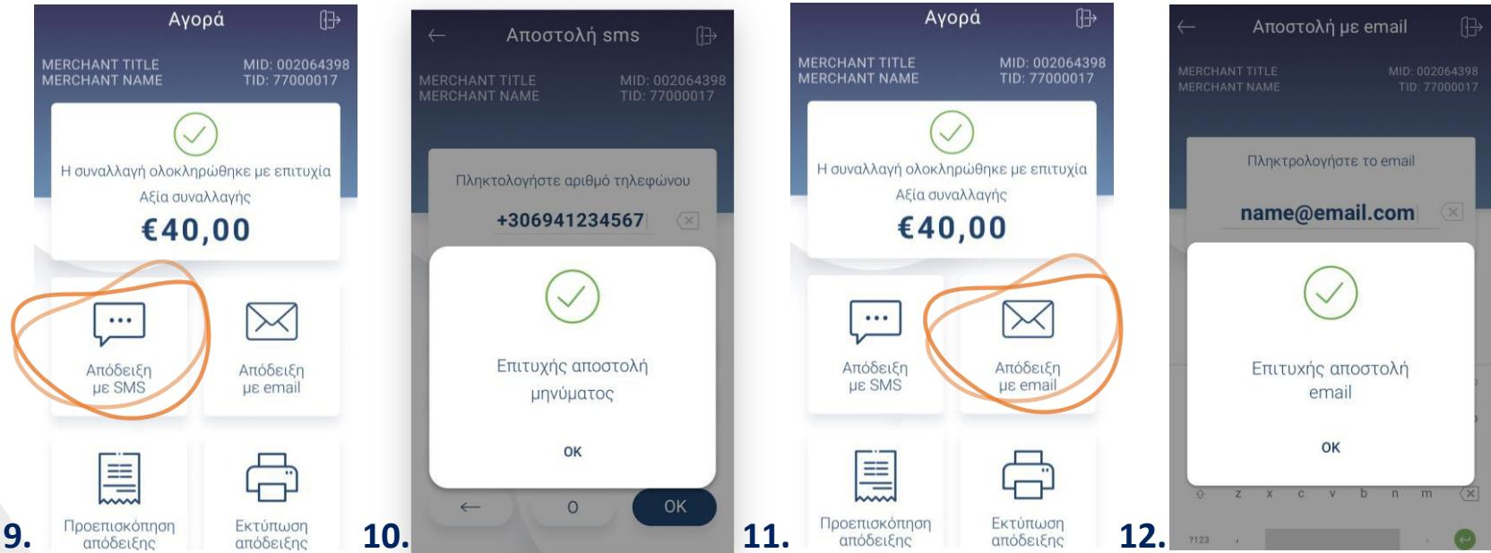
9. **SMS:** Μπορείτε να στείλετε το απόκομμα συναλλαγής μέσω SMS. Πληκτρολογήστε τον αριθμό κινητού τηλεφώνου του πελάτη και πατήστε **OK**. Με την ολοκλήρωση θα εμφανιστεί το μήνυμα «Επιτυχής αποστολή μηνύματος». Πατήστε **OK**. (Εικόνες 9 & 10)
