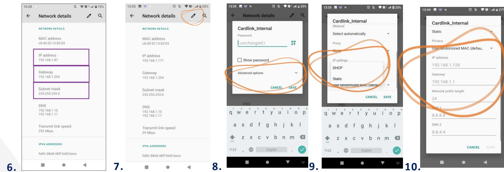
6. Στην οθόνη Network details θα δείτε τις καταχωρημένες τιμές IP, Subnet mask, Gateway του POS σας για να τις καταχωρήσετε σε static. (Εικόνα 6)
